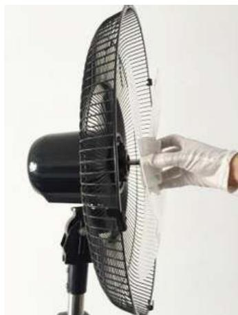
5) Borg het mes met de bevestigingsmoer (2) door het tegen de wijzers van de klok in te draaien.
