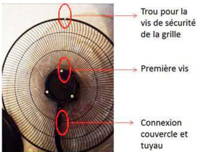
El agujero para el tornillo de seguridad, el primer tornillo en la parte superior, debe estar correctamente alineado con la salida de la tubería.
