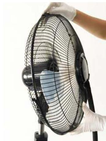
Controleer of het blad vrij kan draaien door het met de hand te draaien.
