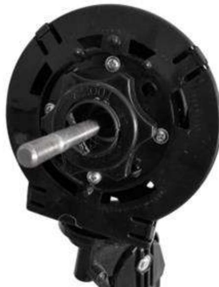
2)Ajuste la rejilla trasera (5) colocándola en las muescas (p) y fije la rejilla (5) al motor con la tuerca de fijación de la rejilla (4).
