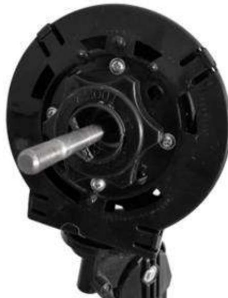
2) Ajustez la grille arrière (5) en la positionnant sur les crans (p) et fixez la grille (5) sur le moteur avec l'écrou de fixation de la grille (4).
