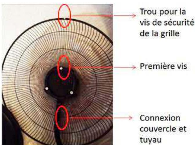
Het gat voor de veiligheidsschroef, de eerste schroef aan de bovenkant, moet goed zijn uitgelijnd met de buisuitlaat.
